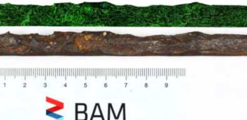
Probe aus Chloridbereichen
