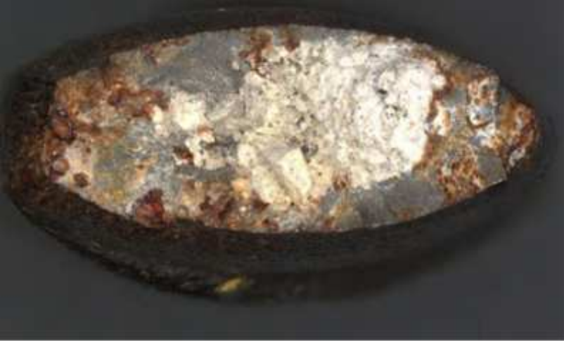
Mikroskopieaufnahme der Bruchfläche, Mörtelreste erkennbar
